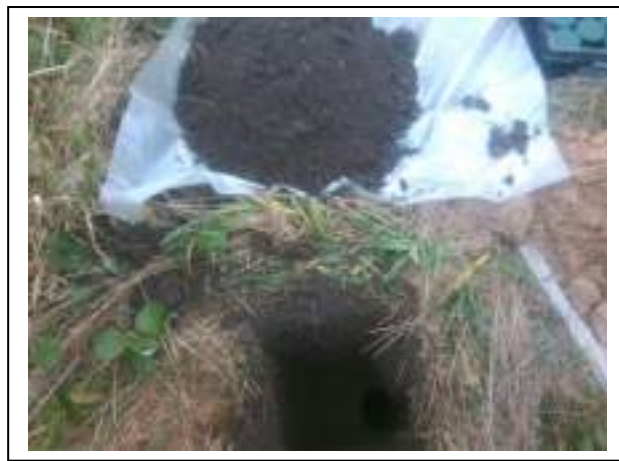
Foto 6. Opgegraven en gezeefd materiaal asbestinspectiegat C06
