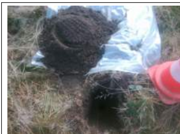
Foto 11. Opgegraven en gezeefd materiaal asbestinspectiegat D03
