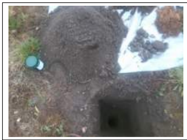
Foto 4. Opgegraven en gezeefd materiaal asbestinspectiegat C04
