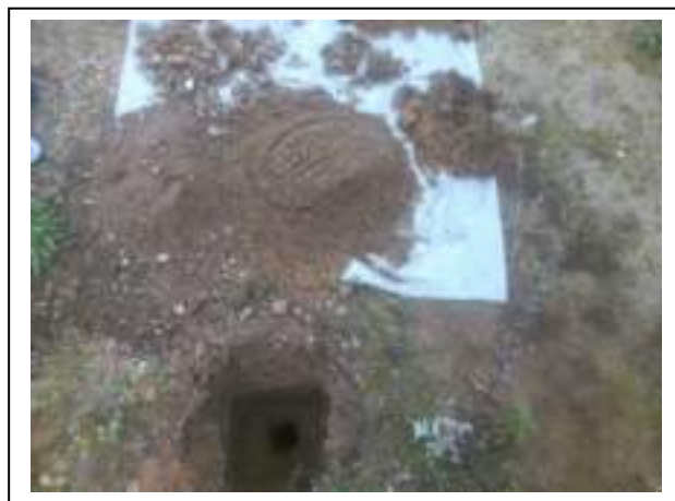
Foto 2. Opgegraven en gezeefd materiaal asbestinspectiegat C02
